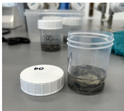
(d) Arresting hydration in acetone solution
