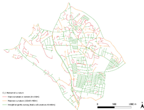
C1,1 Horizontal curvature
