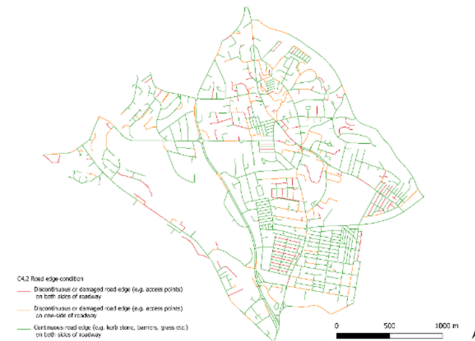
C4,2 Road edge condition
