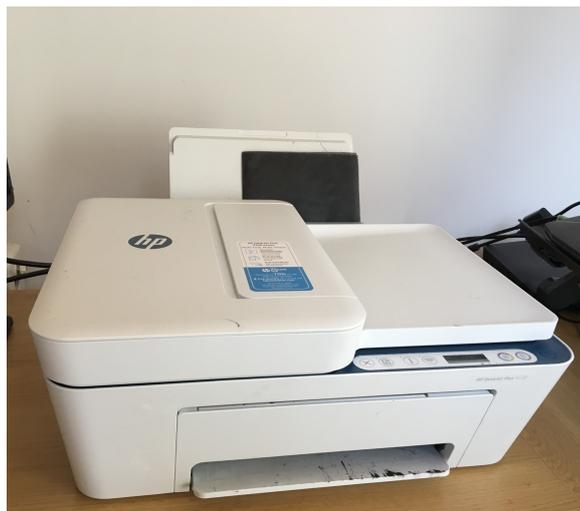
Fig. 3.7 HP Deskjet Plus 4130 drop-on-demand thermal inkjet printer
