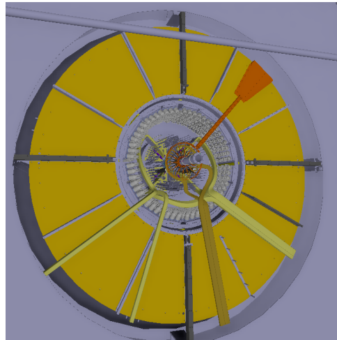
(d) ID with the heater trays removed
