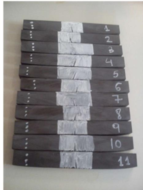
Figura 6. Vista de las probetas en las que la grieta crecerá perpendicular a la dirección de las fibras tras los procesos de fabricación y mecanizado.
