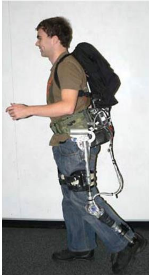
Figure 2.16 MIT Quassi passive exoskeleton (Walsh et al., 2007)
