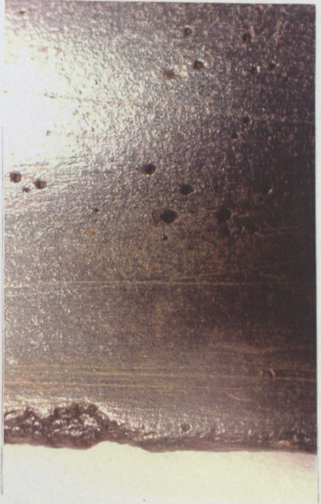
(iii) Surface porosity (NMS DQ 306)
