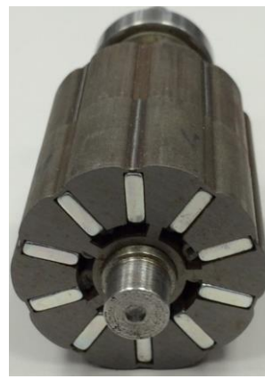
(d) Step-staggered rotor with alternate airspace barriers
