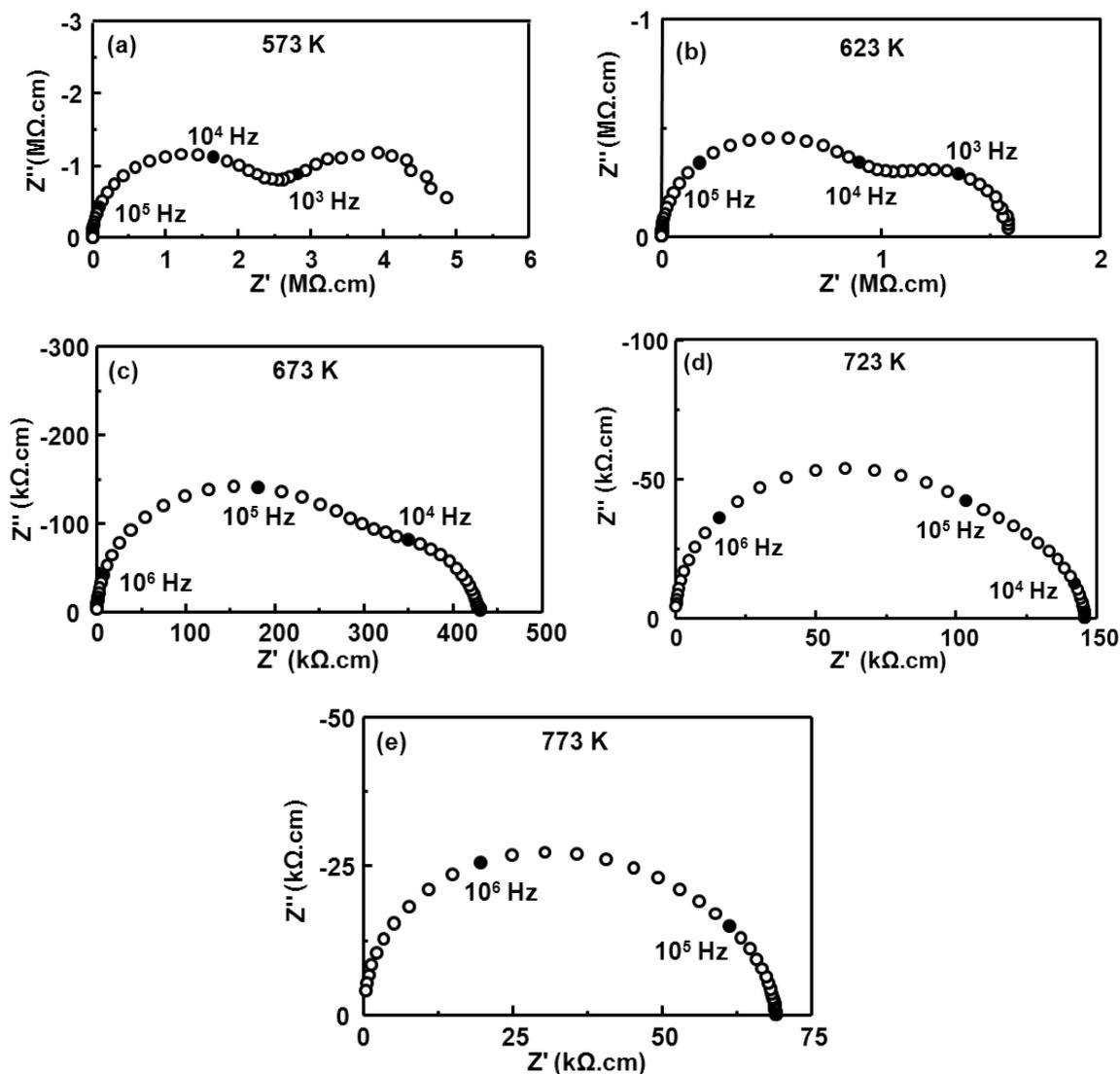
**Figure 3.8**  $Z^*$  plots for  $\text{Bi}_{12}\text{SiO}_{20}$  ceramics at (a) 573, (b) 623, (c) 673, (d) 723 and (e) 773 K.
