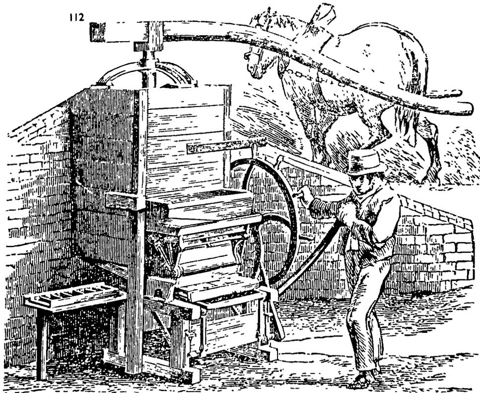
Figure 6.4. Hall's patent brick-moulding machine, British Patent No. 10,845, 1845, Frederick Ransome, Assignee. [From Catalogue Illustré des Machines et Instrumens Fabrique par Ransomes et Sims, Juin 1859 and John Woodforde, Bricks to Build a House (1976)]
