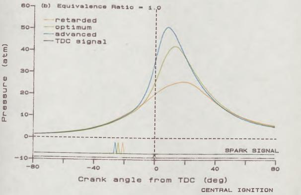
COMPRESSION RATIO - 8.0 ENGINE SPEED - 1400 rpm
