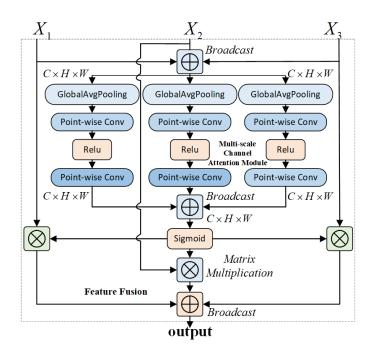
Fig. 5-7. Multiscale feature fusion module.
