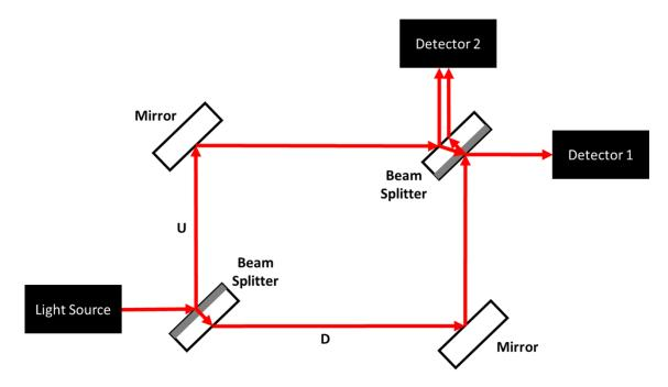
Figure 2.10: Mach-Zehnder Interferometer
