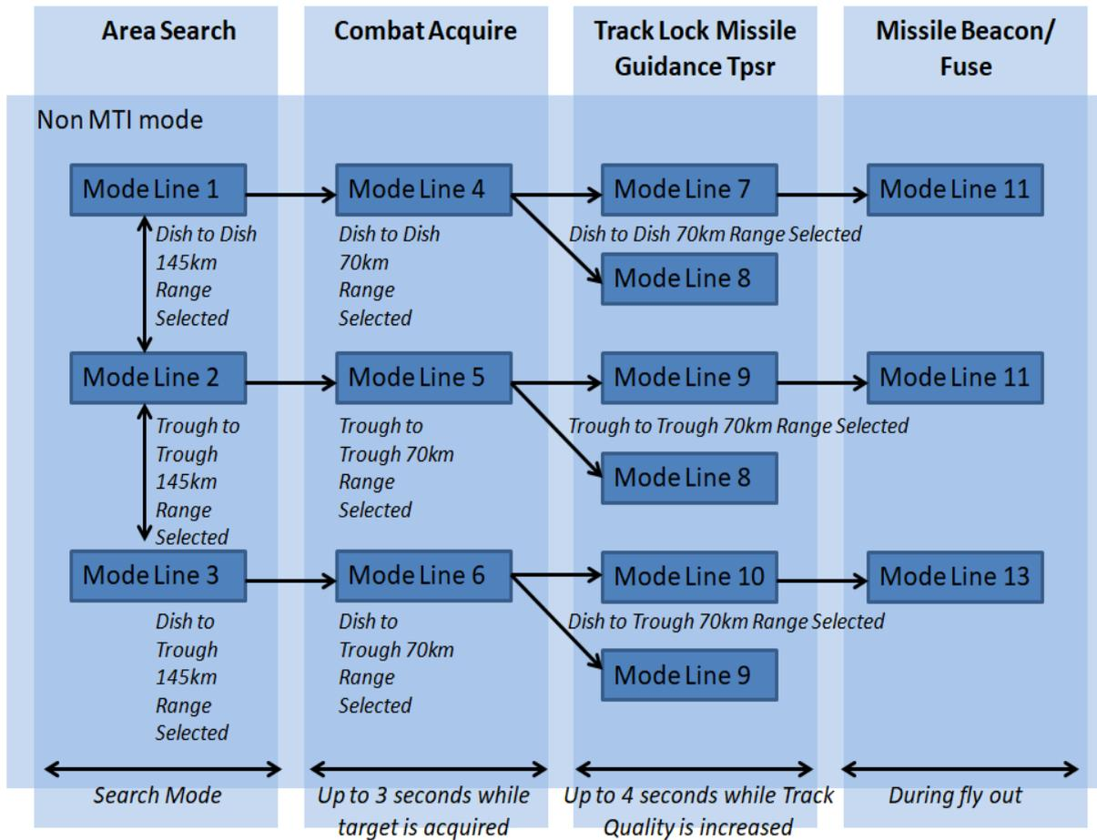
FIGURE 13 MODE LINE PERMUTATION DIAGRAM FOR AUTO TRACK AS SWIM LANES [J5]
