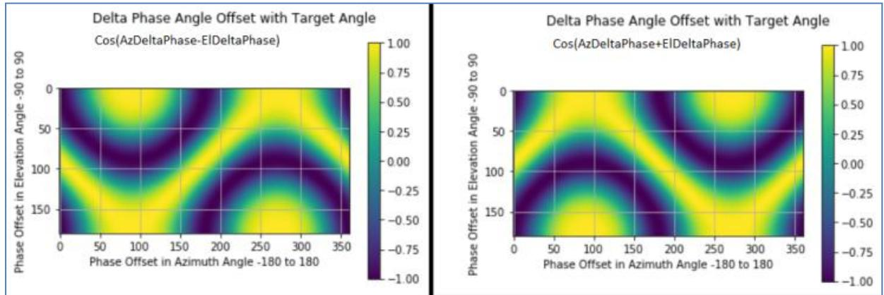
FIGURE 56 DELTA PHASE ( $\Delta\phi$ ) OFFSET FOR OFF BORE-SIGHT ANGLES (TEST MODULE)
