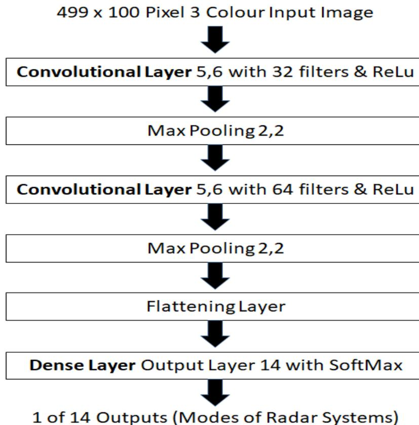
FIGURE 49 EMITTER IDENTIFICATION MODEL ARCHITECTURE
