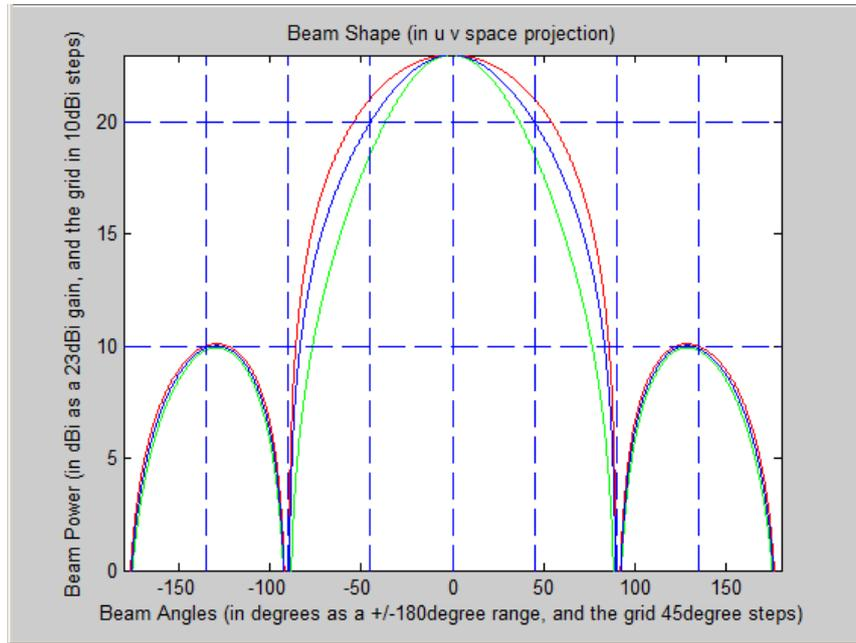
FIGURE 57 BEAM SHAPING FOR ACCURATE 3DB POINT LOCATION TO ANGLE (TEST MODULE)
