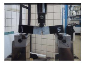
Figura 7. Vista de la rotura de una probeta con crecimiento de la grieta paralelo a las fibras, en el ensayo de flexión en tres puntos.
