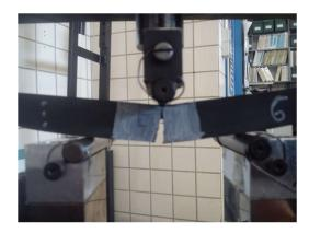
Figura 10. Vista de la rotura de una probeta con crecimiento de la grieta perpendicular a las fibras, en el ensayo de flexión en tres puntos.
