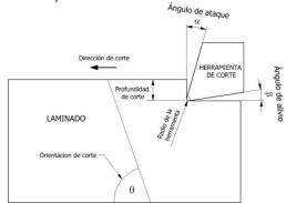
Figura 1. Parámetros de corte considerados en operaciones de corte ortogonal.
