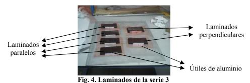
Los útiles que se emplean para realizar las pregrietas en los laminados son distintos para cada tipo de laminado. En el laminado paralelo se usan dos útiles en los bordes de lado largo, de forma que introduce la cuchilla en la mitad de este lado.
