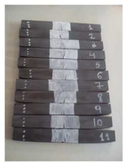
Figura 6. Vista de las probetas en las que la grieta crecerá perpendicular a la dirección de las fibras tras los procesos de fabricación y mecanizado.
