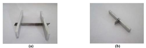
Fig. 5. Útiles de aluminio de la serie 3: (a) útil del laminado perpendicular, (b) útil del laminado paralelo.
