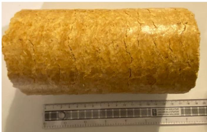
**Figure 3.8: Bracken burn briquettes 'Brackettes'**
